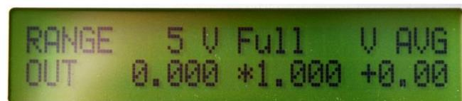
Zur optimalen Ausnutzung des angewählten Messbereichs und damit auch Optimierung der Messgenauigkeit und der Messauflösung kann der Verstärker die Multiplikationskonstante zwischen Eingang und Ausgang im Bereich 0,500 bis 3,600 variieren. Außerdem ist es möglich, die Ausgangsspannung mit einem Offset zu beaufschlagen, um damit eine Ausgangsspannungsverschiebung im vollen Bereich vornehmen zu können.
